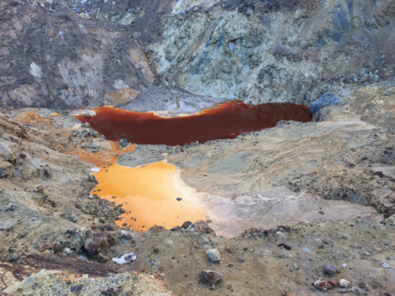
Սյունիքի մարզում գտնվող Կավարտի լքված հանքավայրի թթվային դրենաժի վառ օրինակ (Նկարի աղբյուրը՝ ՀԱՀ Պատասխանատու հանքարդյունաբերության կենտրոն)
